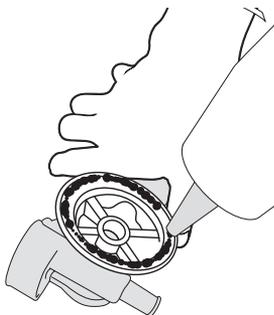
Рисунок 10. Нанесите герметик
